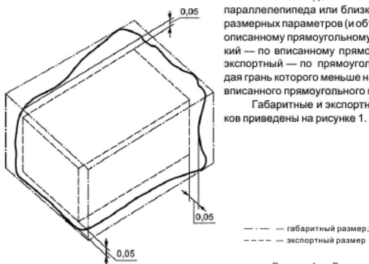
Рисунок 1 — Размерные параметры блоков
